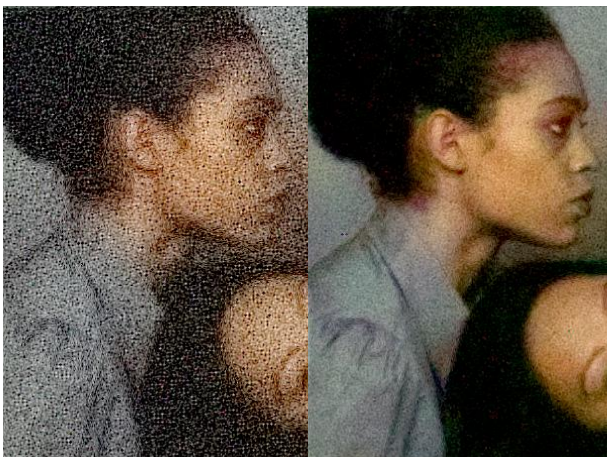
图 3：在低 D65 光照下，采用本文提出的 RGBC-IR 图像传感器拍摄的“TE42”测试图局部区域图像。直观对比红外照明开启/关闭时的成像效果差异，左图为红外照明关闭状态，右图为红外照明开启状态。
